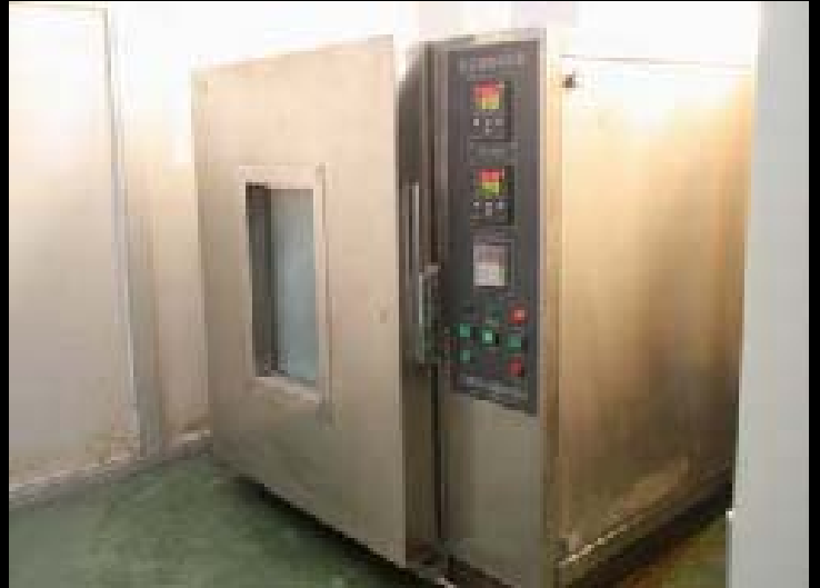
Thermal Heat Shock
